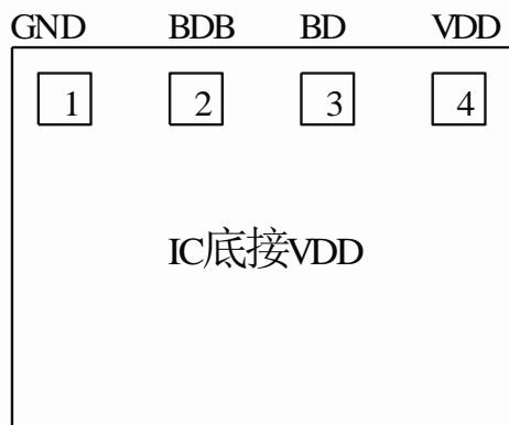
备注: IC 底座接接 VDD, IC 尺寸 800UM\*1000UM
