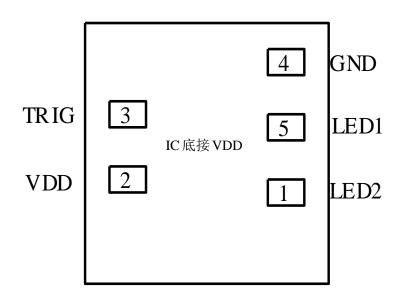
备注: IC 底座接接 VDD, IC 尺寸 1300UM\*1200UM
