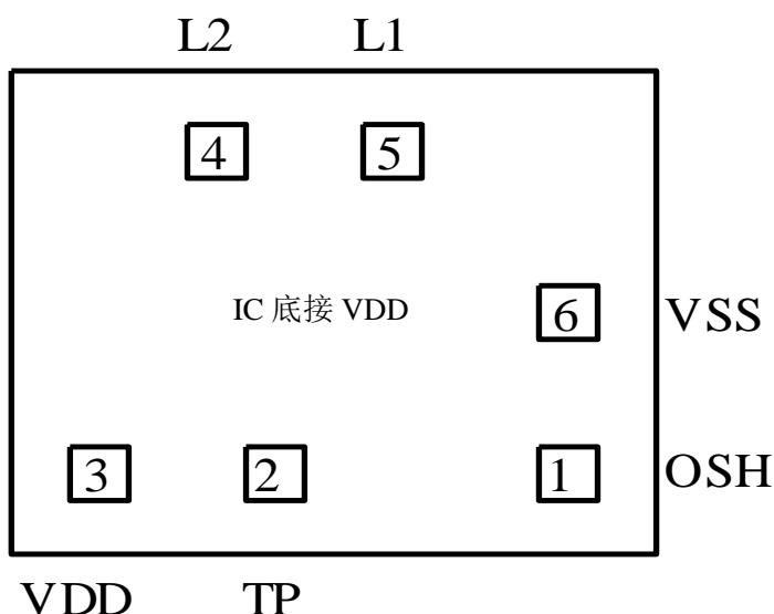
备注: IC 底座接接 VDD, IC 尺寸 1200UM\*1000UM
