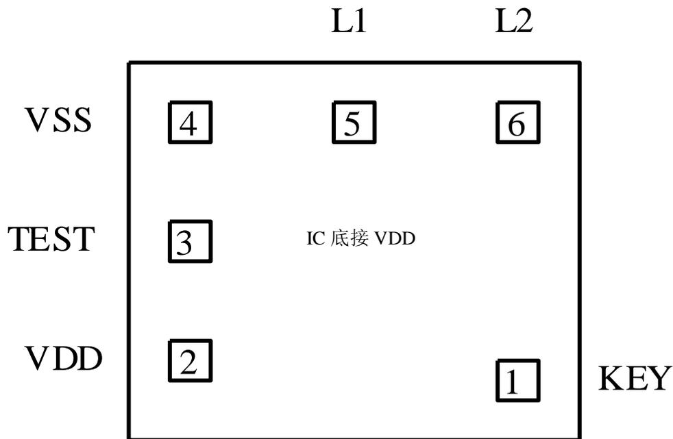
备注：IC 底座接 VDD，IC 尺寸 800UM\*1000UM
