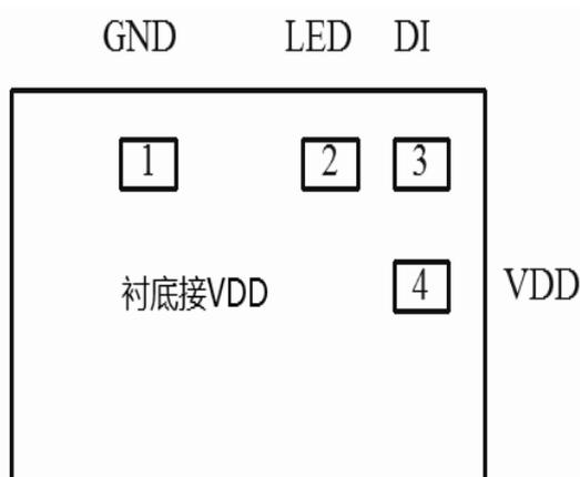
注: IC 底座接 VDD,IC 尺寸 900UM\*1000UM
