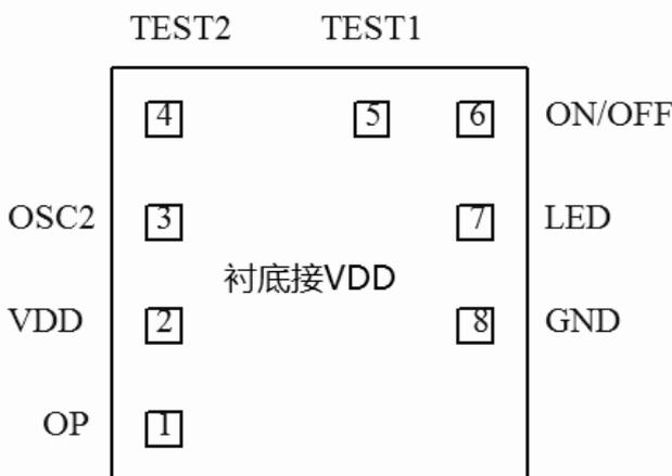
备注：IC 底座接接 VDD，IC 尺寸 1000UM\*1000UM
