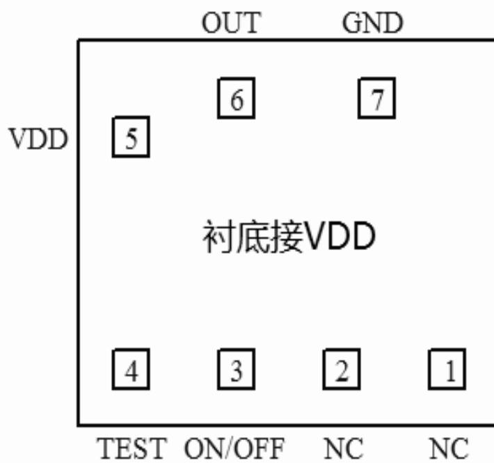
备注：IC 底座接接 VDD, IC 尺寸 850UM\*900UM
