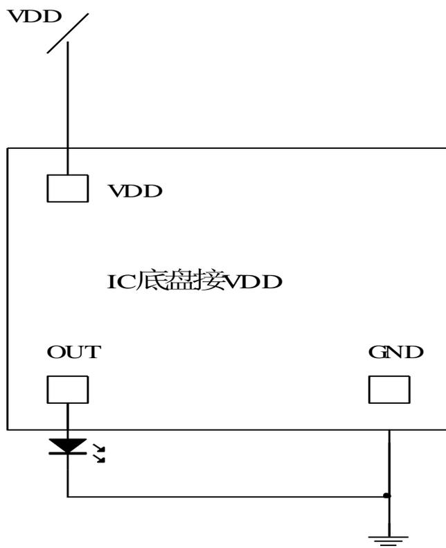
注： THE IC SUBSTRATE SHOULD BE CONNECTED TO VDD
